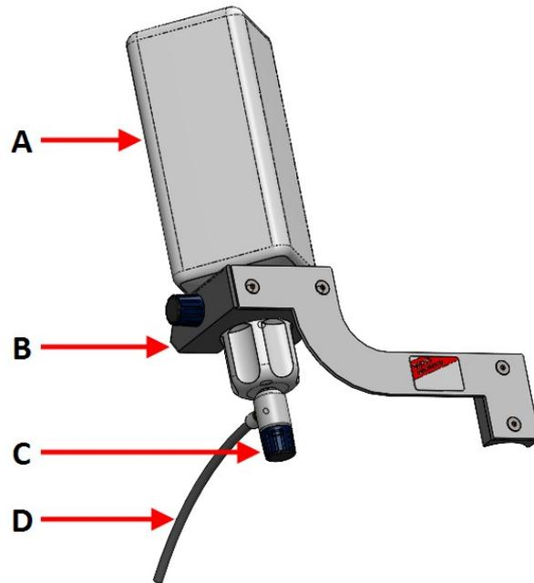
1. Utilizzare la staffa e le due viti per montare il braccio dosatore sulla colonna della macchina.
