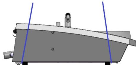
2. Sollevare la parte anteriore della macchina e spostarla con cautela sul tavolo utilizzando le ruote all'estremità posteriore della macchina.
